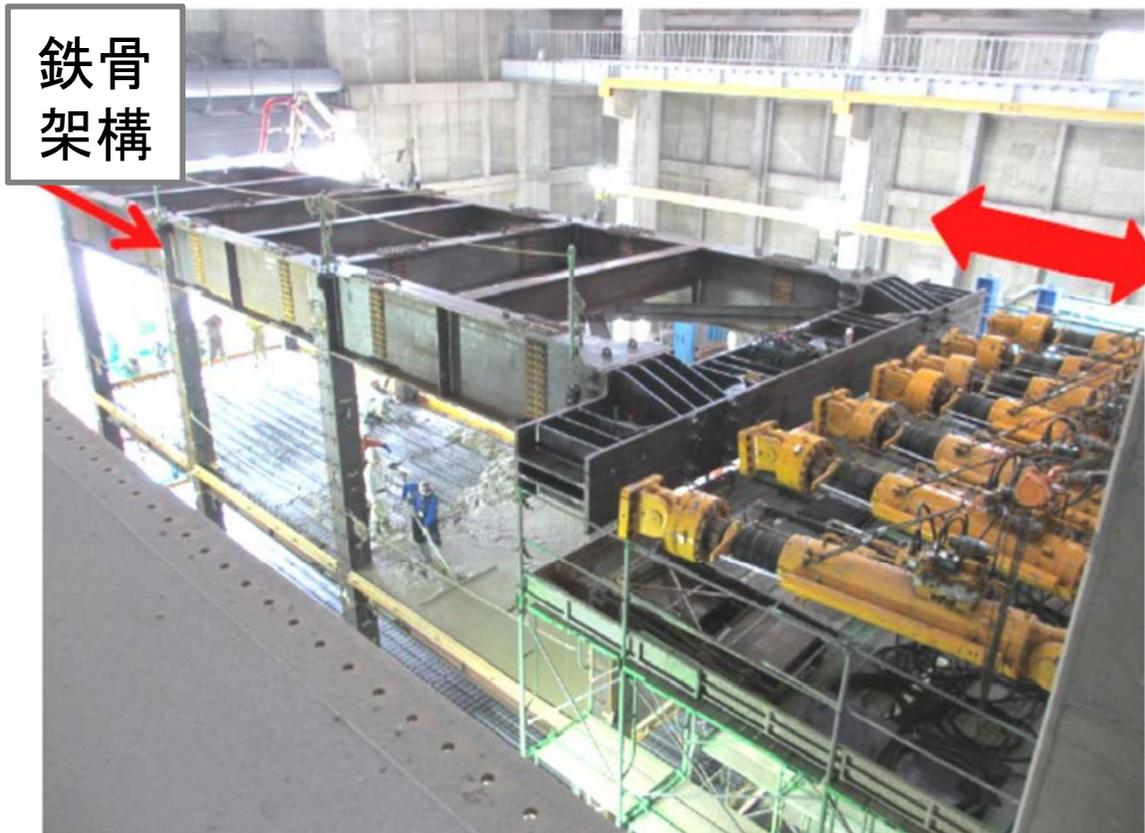
鉄骨実大架構の多数回繰り返し加力実験
